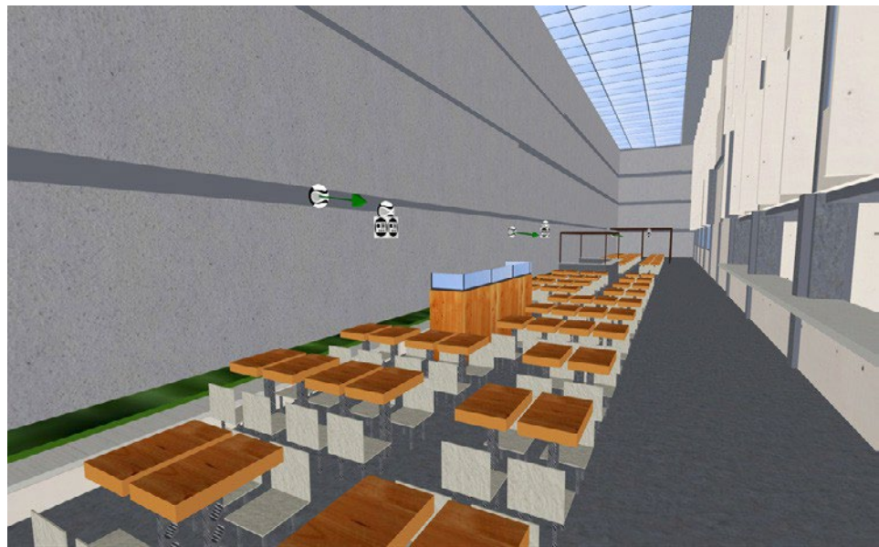
Figure 29 : Points d'irradiation tels qu'ils ont été modélisés dans iBwave Design..
