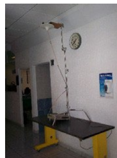
Figure 3 : Niveau 2 intérieur et configuration de la mesure (700, 850 & 2400 MHz).
