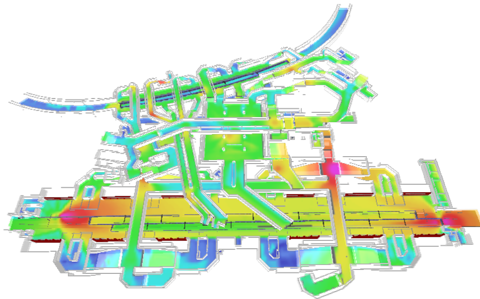
Figure 14 : Couverture GSM à la station
