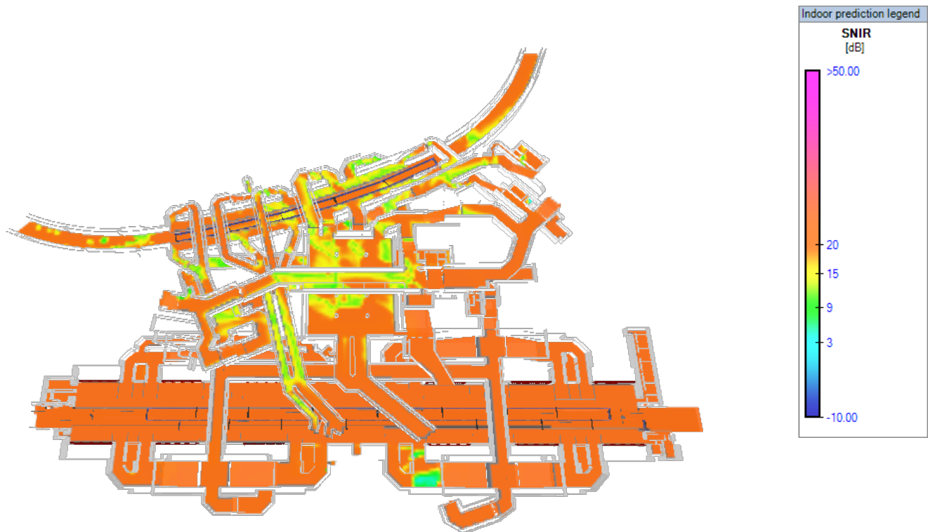
Figure 9 : Couverture HSPA SINR utilisée pour l'exemple de dimensionnement de la capacité de transmission de données
