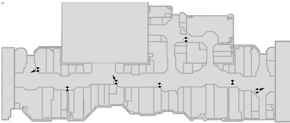
Figure 9 : Emplacement des antennes DAS au niveau supérieur
