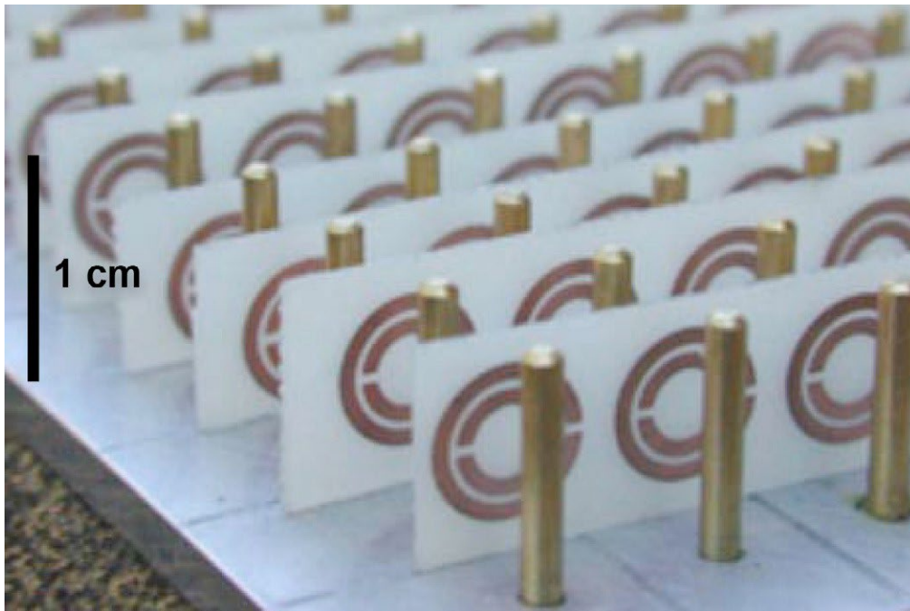
Figure 2 : Métamatériau à indice de réfraction négatif (NRI) pour les hyperfréquences, constitué de couches alternées de fil métallique fin et de résonateurs circulaires à anneau fendu (SRR) [1].
