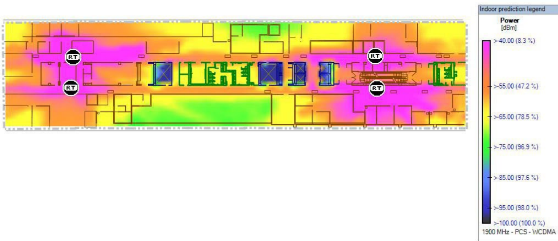
Figure 5 : Couverture RF à l'intérieur d'un bâtiment à l'aide de petites cellules omnidirectionnelles
