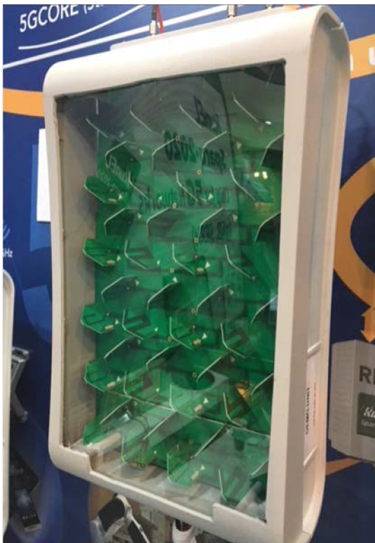
Figure 4 : Station de base prête pour la 5G avec 44 antennes à polarisation croisée dans un panneau
